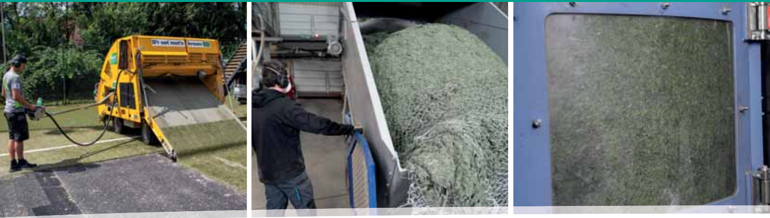
Fotos v.l.n.r.: Aufnahmen des alten Kunststoffrasens | Aufnahme des geschredderten alten Kunststoffrasens in die Agglomerationsanlage Agglomeration in der Recyclinganlage
